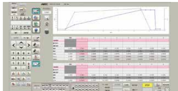
圈数程序屏幕 (节距图：锥形弹簧成型示例) 可以自由分别创建与编辑节距与外径的程序，可简单且轻松的调整压簧外观与尺寸。
